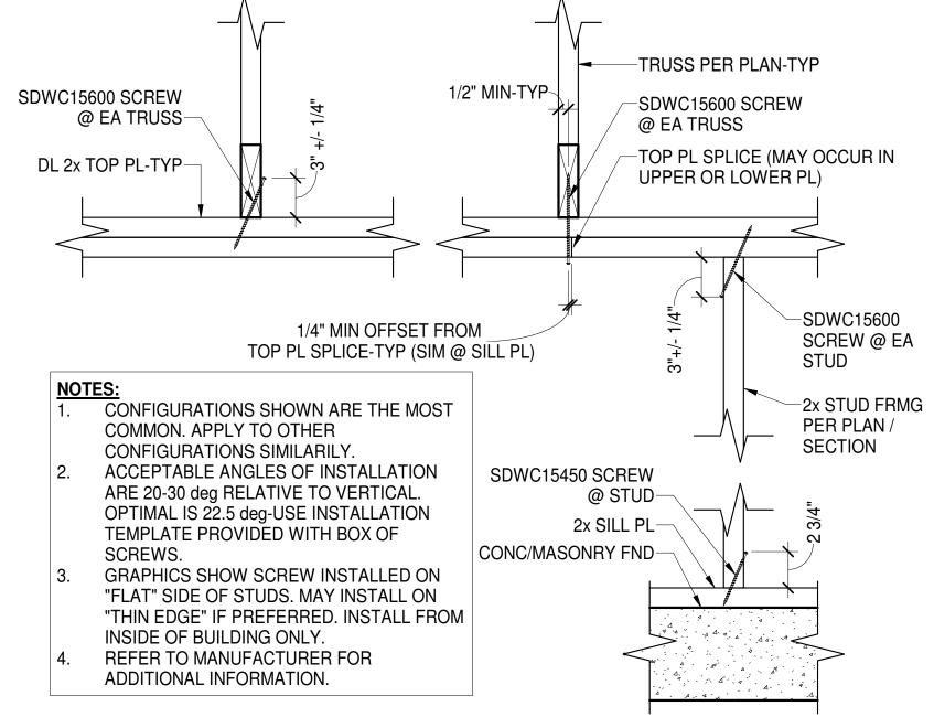
**E TYPICAL SIMPSON SDWC TRUSS SCREW DETAIL** ժ S1.5 է N.T.S.
