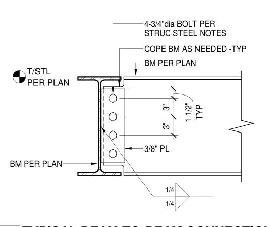
H TYPICAL BEAM-TO-BEAM CONNECTION | S1.5 \ N.T.S.
