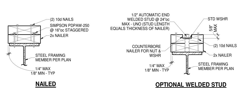
K TYP DOUBLE NAILER ON BEAM | S1.5 | N.T.S.
